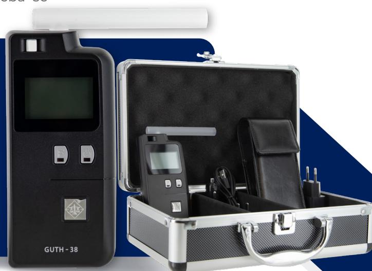
Cuenta con una celda de combustión electroquímica para medir la concentración de alcohol. Si hay presencia de alcohol, un voltaje correspondiente es generado por la celda de combustión, el cual es proporcional al contenido de alcohol de la muestra tomada. Este voltaje es enviado al CPU y convertido a "BrAC", el cual es mostrado en la pantalla del instrumento.
